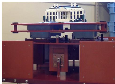
図2 磁気浮上型超電導免震装置
