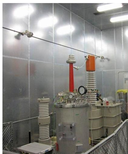
図：シールドルームに置かれた高電圧印加試験用クライオスタット
