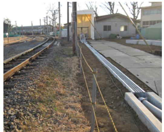
図5 製作・敷設した30 m長鉄道用超電導ケーブル (鉄道総研 構内試験線)
