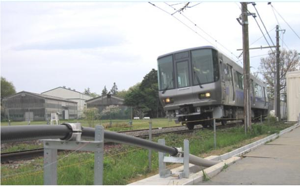
図8 超電導ケーブルを用いた車両走行試験
