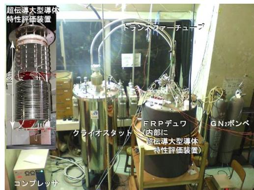
図2 高温超電導大型導体の特性評価装置
