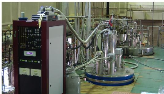
図1 HM室の様子。中心の青い装置が28 T無冷媒ハイブリッドマグネット、奥の銀色は30 Tハイブリッドマグネット。手前左の赤茶色枠ラックは希釈冷凍機の高スピンシステム。
