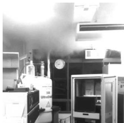
図2 3月11日、20時40分頃に始まった500 MHz NMR装置のクエンチの様子
