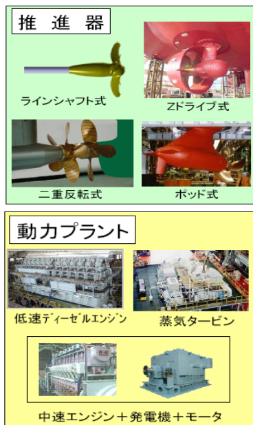
図1 船用推進システム
