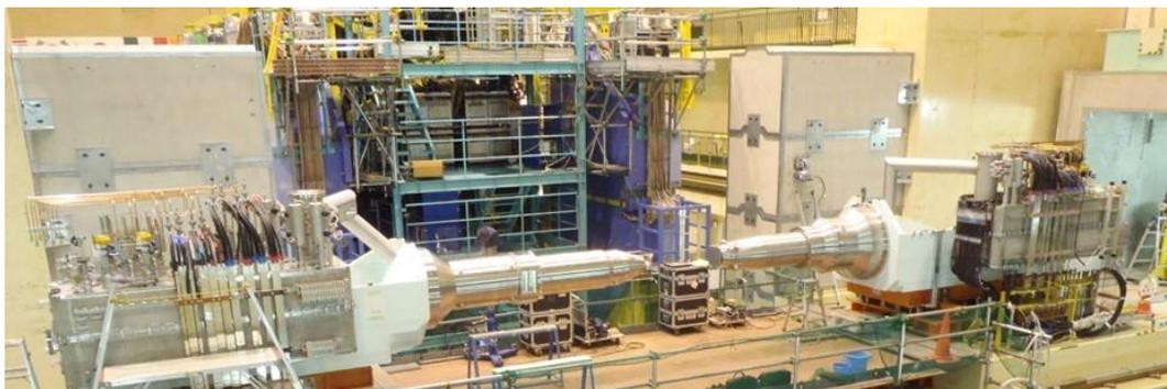
図 1 KEKB 用超伝導電磁石クライオスタット。
