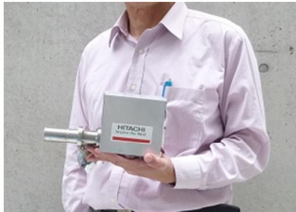
図2. 超小型超伝導バルク磁石
