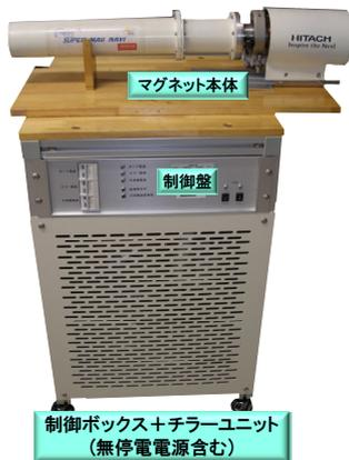
図1. 従来の日立超伝導バルク磁石
