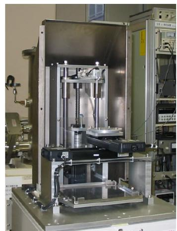
図2 永久磁石を用いた $J_c$ 評価装置の写真
