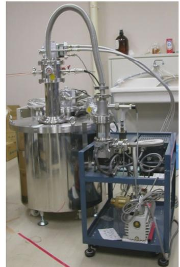
図1 高磁場中で表面抵抗を測定するシステムの写真
