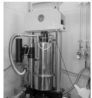
図 高圧下輸送現象測定装置の写真
